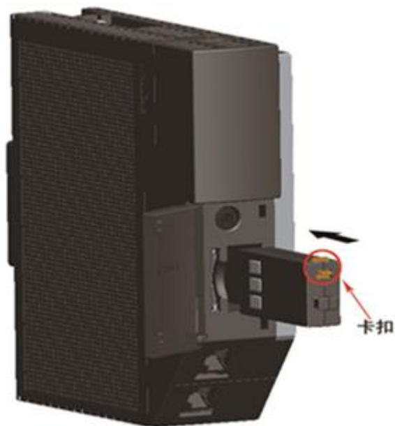
供电盒的安装
