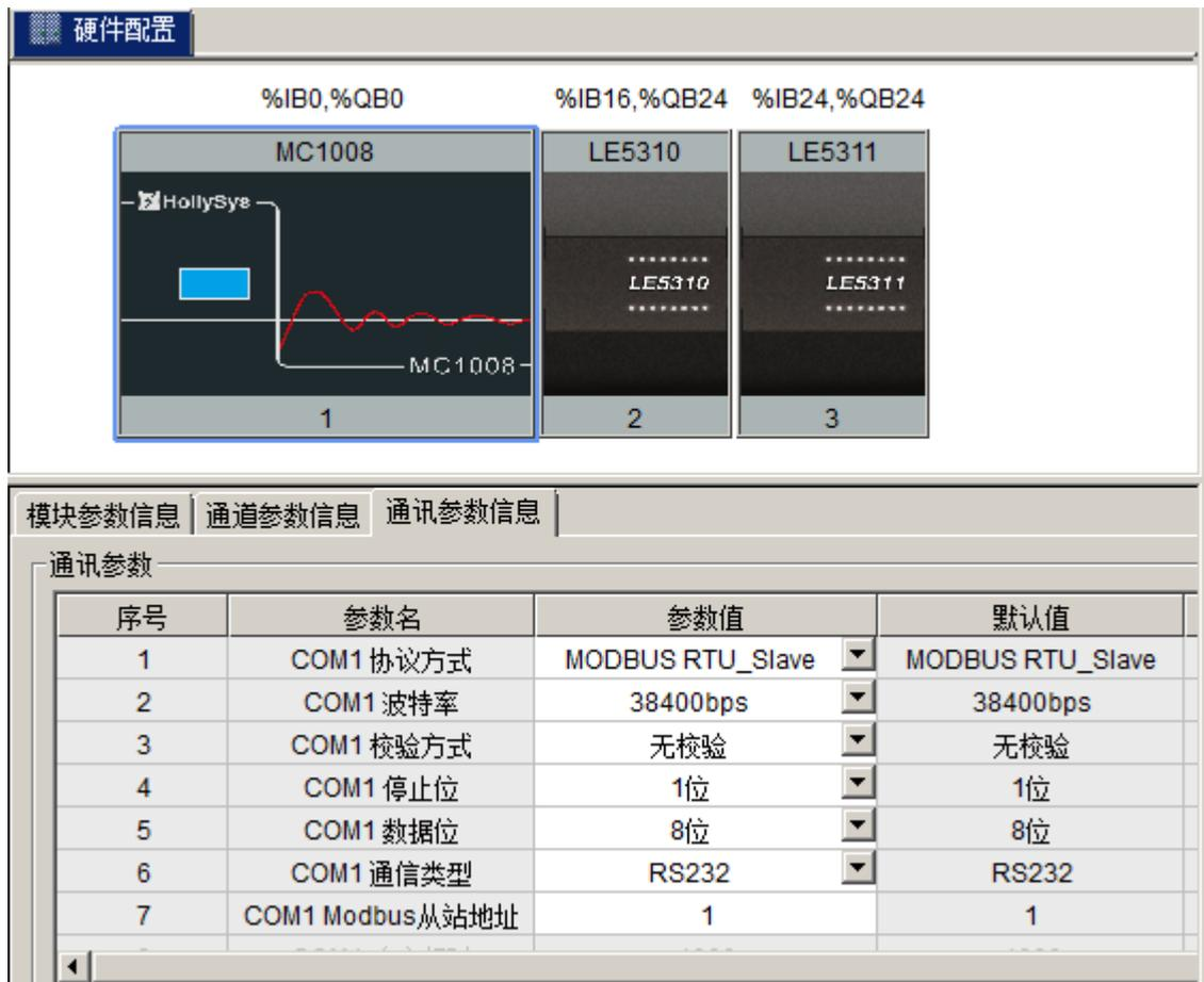
图 5.6-13 MC 工程 CPU 模块通讯参数信息
