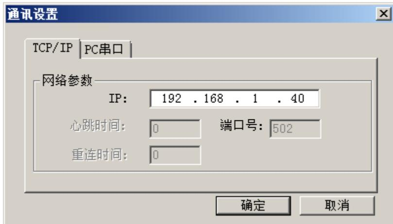
图 4.4-4 LE 工程通讯设置对话框
