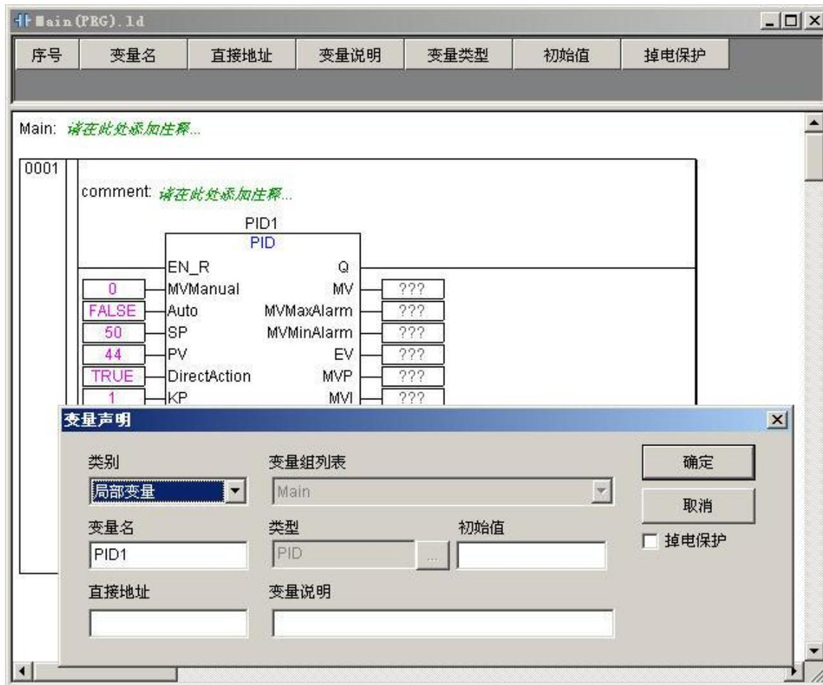
图 5.8-6 PID 指令向导配置完成后弹出变量自动声明对话框
