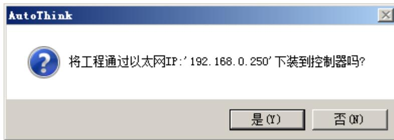
图 5.7-9 MC 工程下装提示信息
