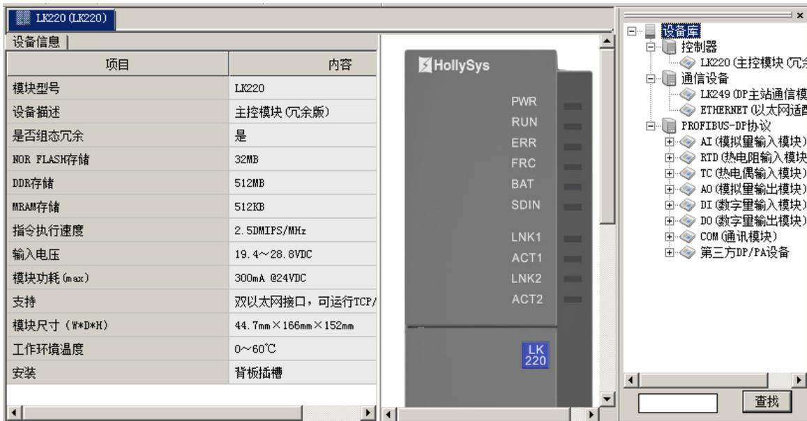
图 5.6-70 LK220 CPU 模块的设备信息窗口
