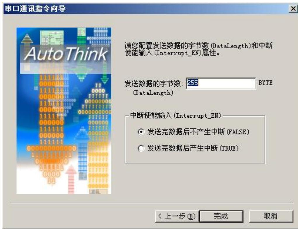
图 5.8-19 发送数据的字节数和中断使能输入属性
