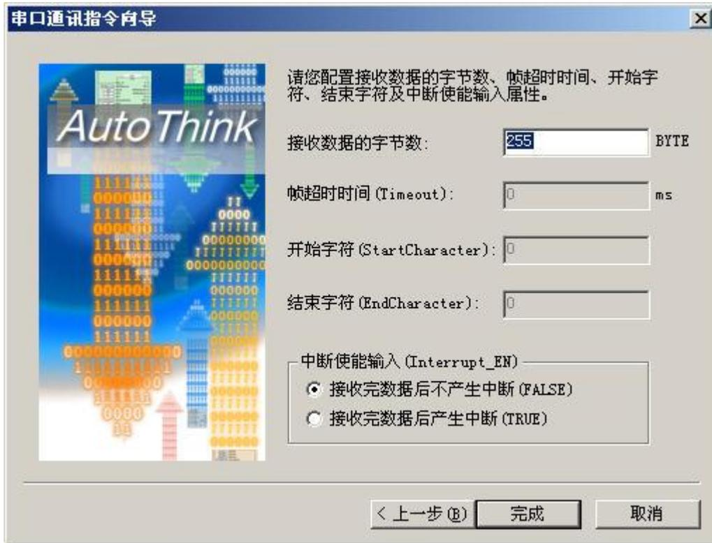
图 5.8-22 接收数据的字节数、帧超时时间、开始字符、结束字符及中断使能输入
