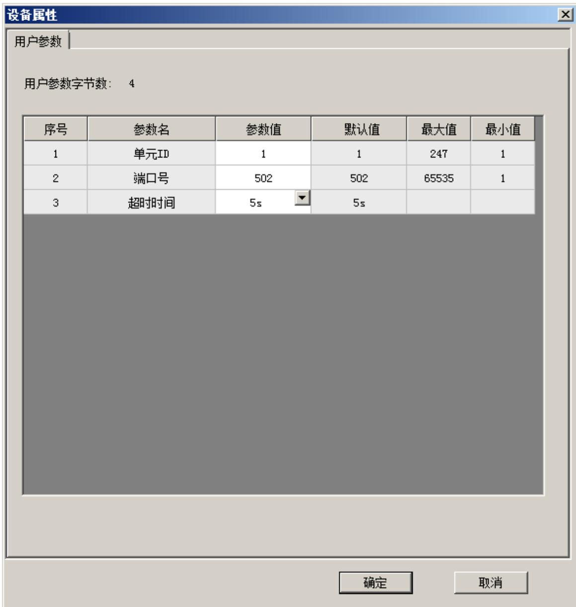
图 5.6-103 MODBUS TCP 从站“设备属性”对话框
