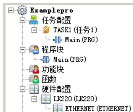
图 5.6-68 LK 工程硬件配置节点
