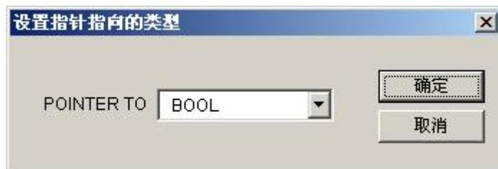
图 5.5-36 指针指向的类型定义对话框
