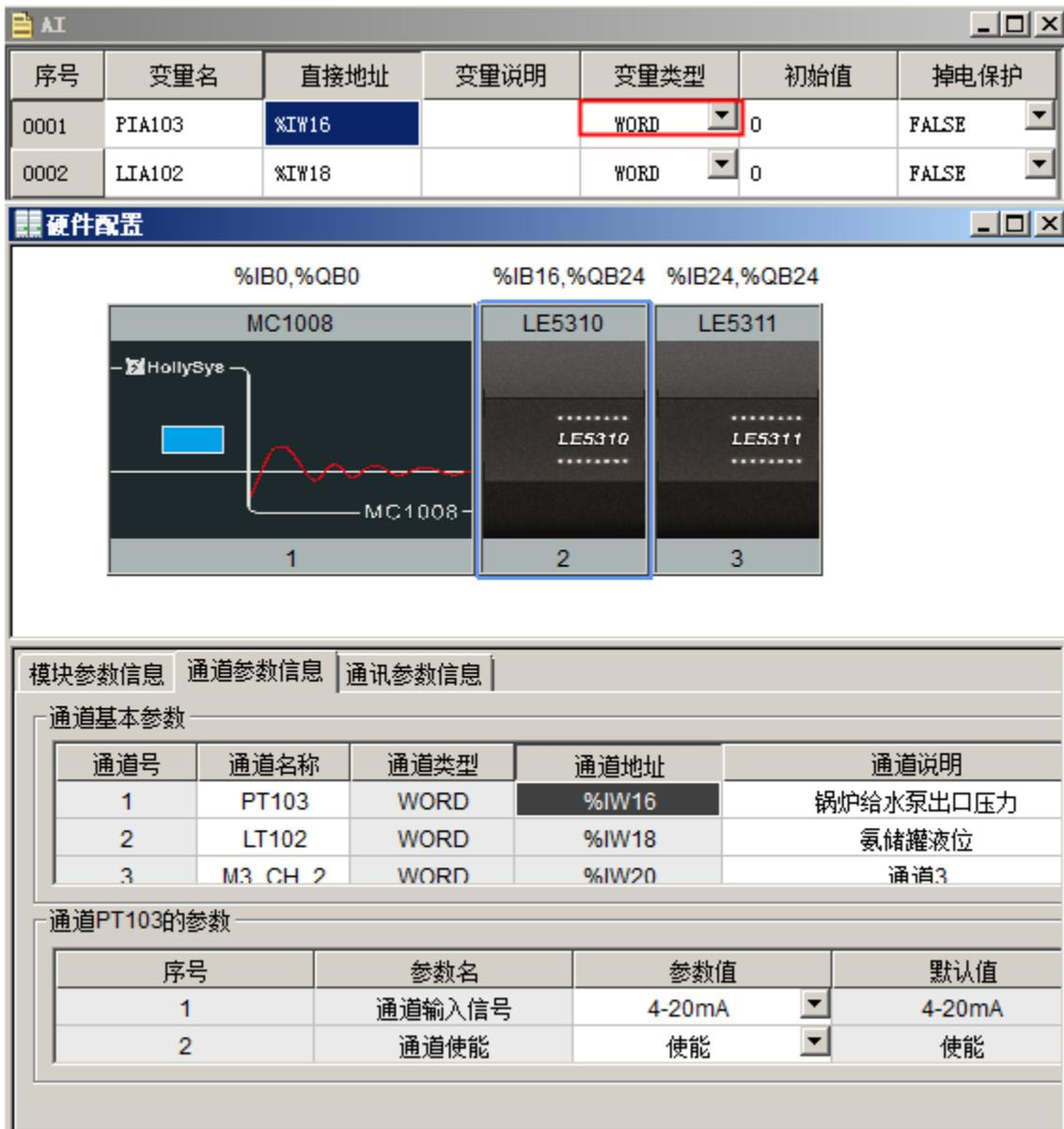
图 5.6-11 模块的通道参数组态
